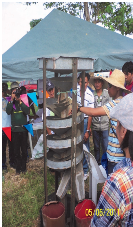
Fig. 21. Sorting using spiral separator
